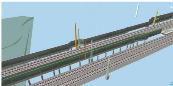
Bild 9: Per automatischer Selektion markierte Fachobjekte des Rückbaus durch Zugehörigkeit der Fachobjekte zur Gruppe „Rückbau“
