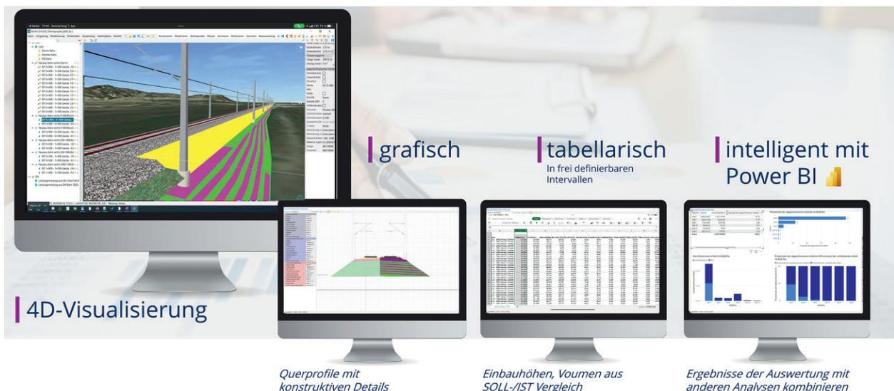
Bild 13: Modellierung und Auswertung des remote erfassten IST-Standes der Baustelle.
