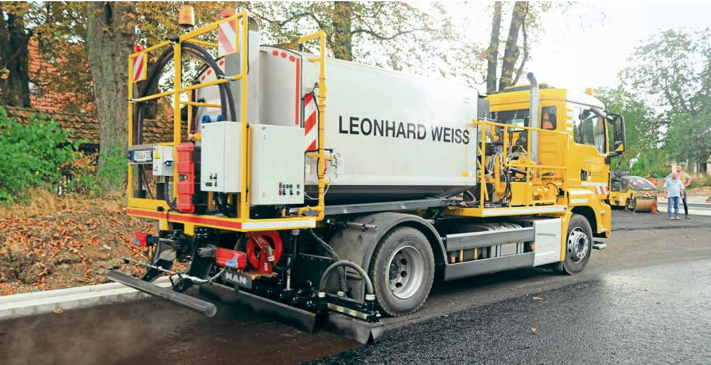
Geeignet auch für C60BP4 S: Universelles Weiro-Rampenspritzgerät der Baureihe HK 1000 PH mit einem 6000 l fassenden, wärmeisolierten Emulsionstank und einem Aufbauomodul zur Naht- und Randversiegelung mit geeigneten Heißbitumenwerkstoffen.
